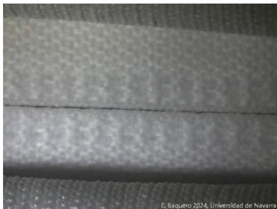
Figura 4 y 5. Microfotografías, una de ellas con escala, de la lámina rígida que protege el acceso a la cremallera. La escala visible en el centro es de un milímetro.
