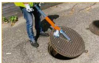
Uso 3: apertura con palanca frontal extendida
